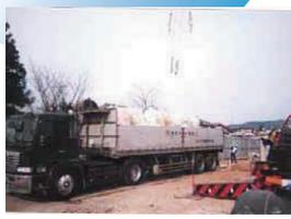
異物(コンクリートガラ、鉄筋、木片等)を選別、除去した後、汚染土壌をダンプトラック等に積み込み、汚染土壌搬出可能な最寄りの当社提携積替保管基地、または埠頭まで運搬します。
