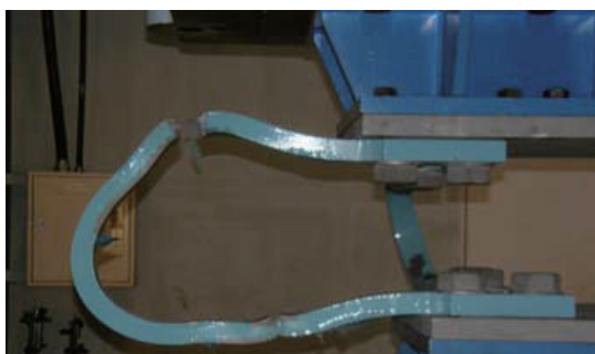
(a)試験体1_0°方向ダンパー破断状況
