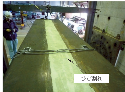
図-10 ひび割れ状況(前面アンカーボルト付近を上面から撮影) Fig. 10 Appearance of crack
