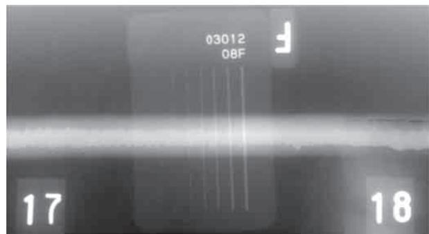
図7 JIS Z 3104透過度計08F(管厚15.1mm)
