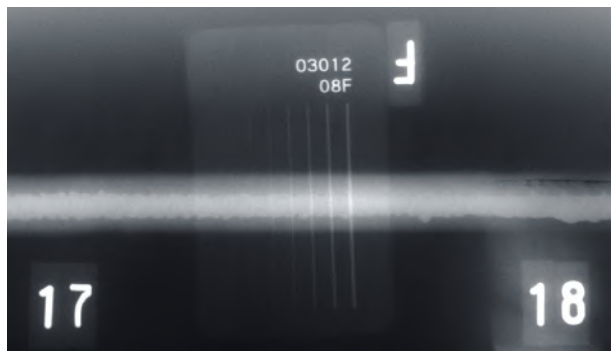
図5 JIS Z 3104透過度計08F(管厚15.1mm)
