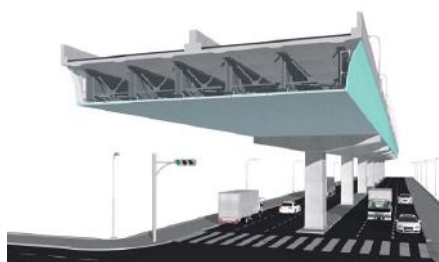
図4 景観仕様側面パネル設置イメージ
