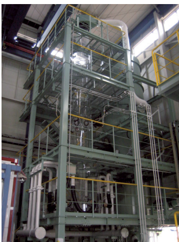
実証機サイズコールドモデル試験装置 シミュレーション流動解析例
