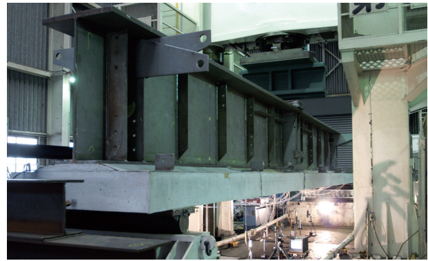
図4 静的荷重試験状況 Fig. 4 Static loading test
