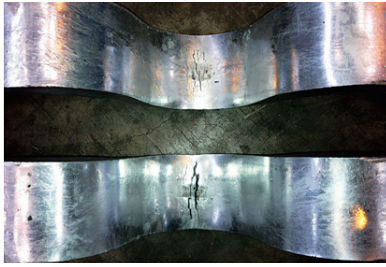
写真-4 実験終了後の供試体凹部 Photo4 Inner Surface of Specimen After the Test
