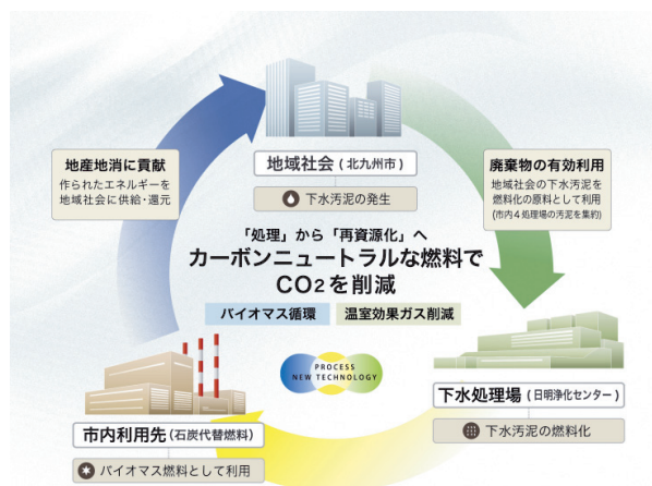
図1 北九州市汚泥燃料化事業の概要図
