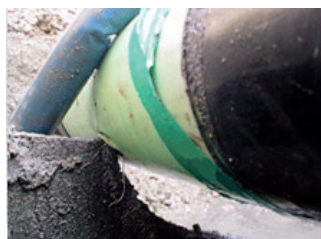
写真4 スーパーコーディンス・テスラで検知したメタルタッチ
