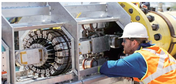
図2 Pipe Explorer の管内挿入の様子
