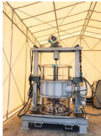
図6 オゾン可溶化反応装置(写真) Fig. 6 Ozone solubilization reactor (photo)
