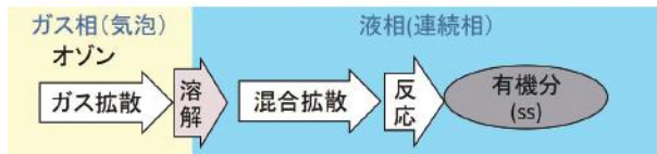
図4 オゾンと有機物の反応経路模式図 Fig. 4 Schematic diagram of reaction
