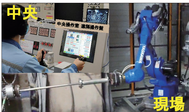
図6 リアルタイム制御/触覚付ロボット
