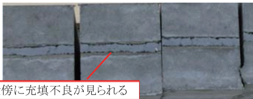
図4 オリジナル試験体①における充填状況の例 Fig. 4 Result of Fillability Test with the Original Specimen No. 1
