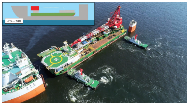
図7 ドライトローイングの様子（第2くろしお進水作業）
