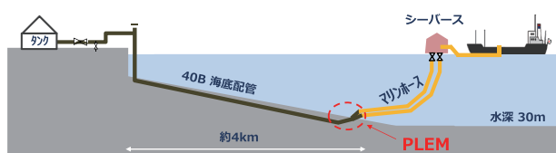
図1 海底配管断面
