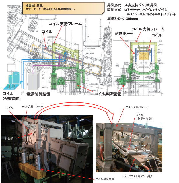
図9 オンライン加熱テスト装置の概要 Fig. 9 Outline of heating device for online test
