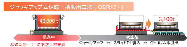
図1 ジャッキアップ式炉底一括搬出工法 Fig. 1 Integral hearth pullout method by jacking up
