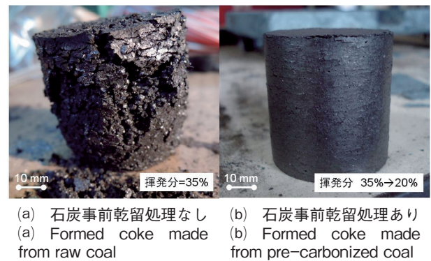
図9 石炭事前乾留処理による成型コークス形状への影響 Fig. 9 The effect of pre-carbonization treatment on formed coke's appearance
