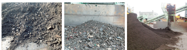
図7 原土(左)、がれき、木くず等(中)、カルシア改質土(右)
