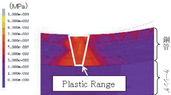
(b)整形荷重1000kN(真円度： \pm 0.2\text{mm} )
