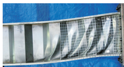
図9 破壊形式：せん断型(試験体1.6_16A)(写真) Fig. 9 Collapse mode: Shear mode(Specimen 1.6_16A)(Photo)
