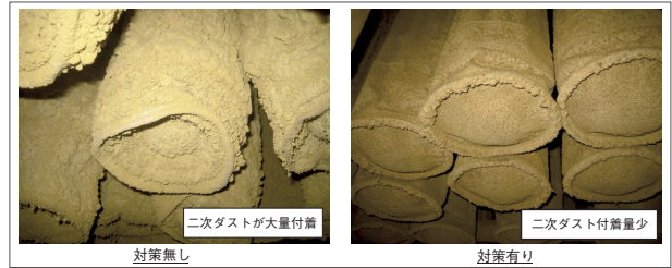
図6 バグフィルターへの二次ダスト付着状況 Fig. 6 Secondary dust sticking at bag filter
