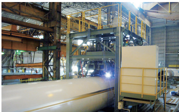
図3 インダイレクトシーム溶接装置 Appearance of the indirect seam welding equipment
