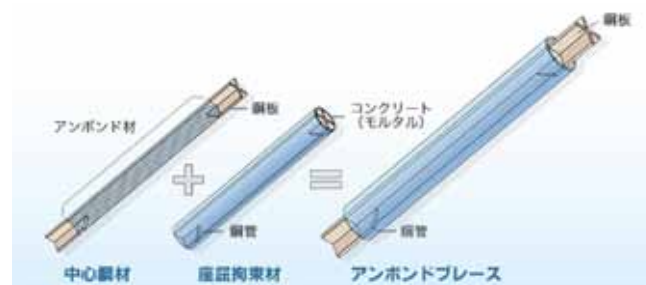
図2 アンボンドブレースの構成
