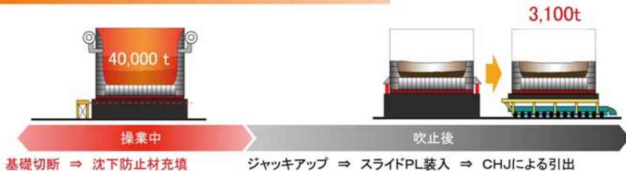
図7 ジャッキアップ式炉底一括搬出工法 Fig.7 Integral hearth pullout method by jacking up
