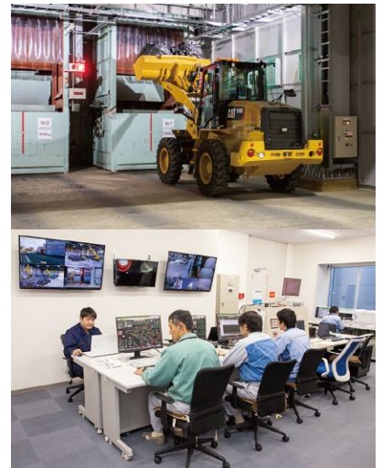
上：コンテナのまま廃棄物を炉に投入できる 下：施設全体を監視・運転する制御室
