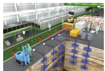
操業中工場での浄化(超多点バイオ工法®)
