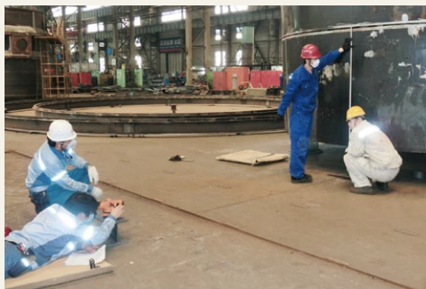
ベンダーの工場で作られた、部材の精度を測定する業務におけるOJTの風景。写真左は混銑車、右は溶鋼鍋。いずれも鉄鋼を製造する際に使われる装置である。
