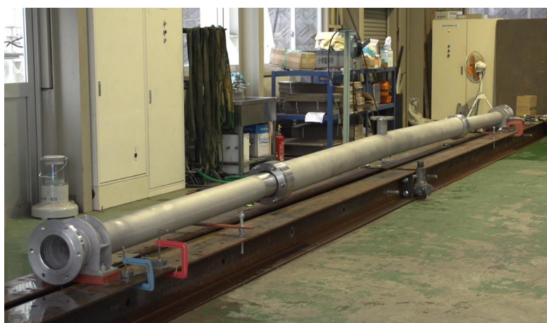
【NSフリースパン水管橋®の全体写真】
