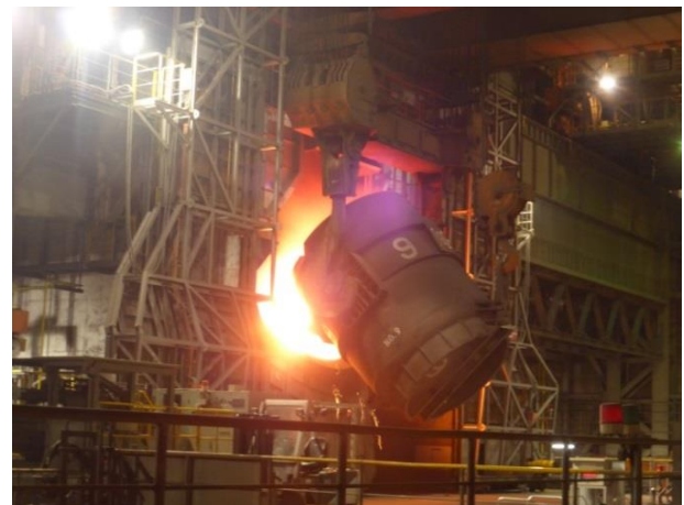
【稼動中の脱りん炉】
