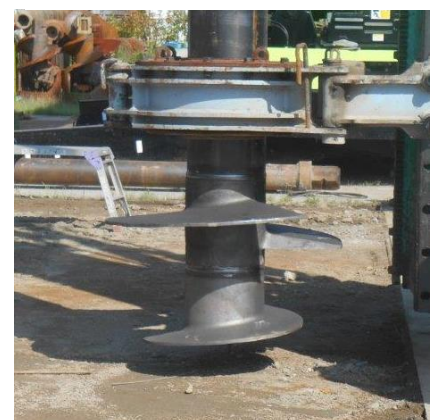
図2 NSエコパイルDUO®の先端羽根部
