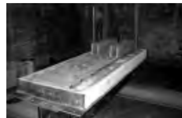
⑤接着工法実大実験・試験体
