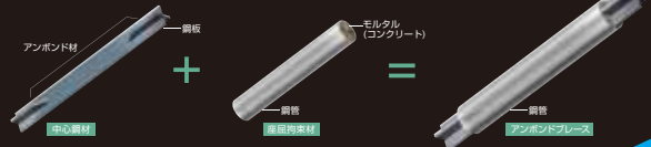
アンボンドブレースの構成
